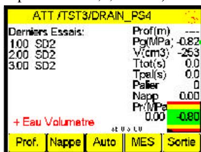
La valise pressio prête, vanne azote ouverte, pression du détendeur positionnée à 55 bars, sonde connectée et positionnée dans le forage
