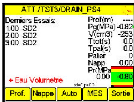
Relancer un essai en suivant est alors possible si votre forage est réalisé, Repositionner votre sonde à la cote de votre nouvel essai.
