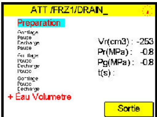
Cliquer sur Dilater lance la procédure de Préparation automatique d'une sonde neuve. Trois cycles de gonflement automatique avec relâchement intermédiaire sont effectuée
